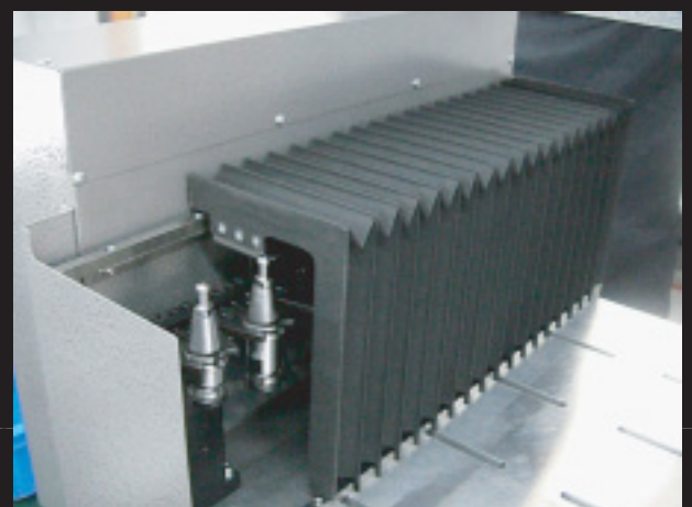
ATCー最大6本までの自動工具交換が可能。 ツール交換時にテーバー部をエアバージ清掃し、 着脱時における粉塵の影響を防止。
