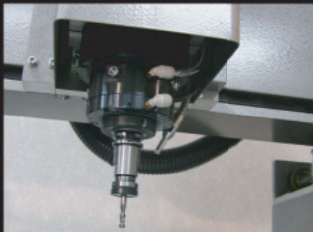
最高回転数18,000rpmの高回転スピンドルに S20Tツールホルダを採用。
